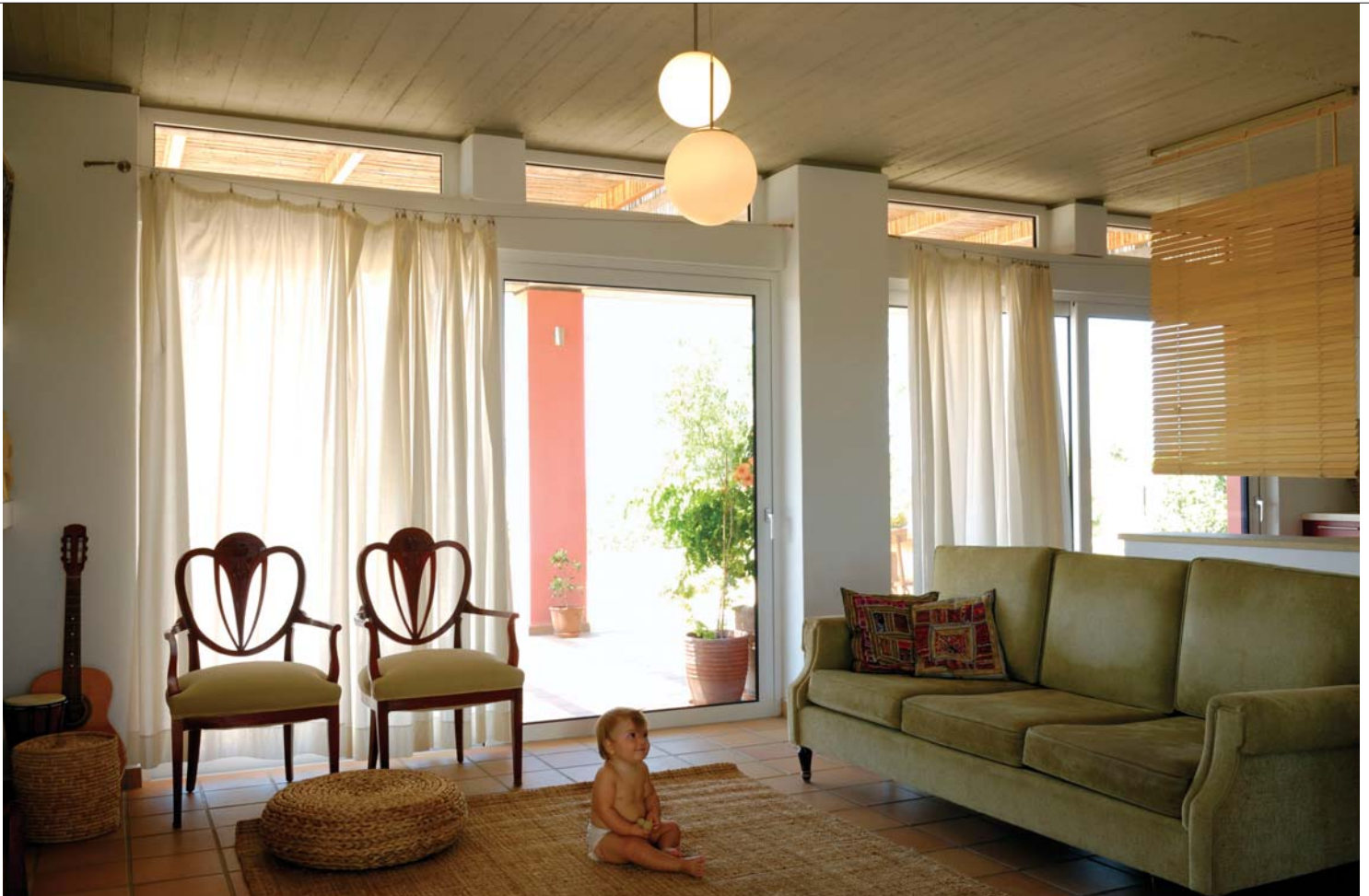
בתמונות: ריצוף באריחי קוטו בעלי מסה תרמית גבוהה, אוגר את השמש בחורף ומשמש לחימום המבנה. תקרות מבטון חשוף - שימוש בחומרים זמינים המצויים באי. פתחים - זכוכית בידודית ופרופילי אלומיניום מבודדים כמערכת בעלת שיעור בידוד גבוה שתורם לחימום שאר רכיבי הקירות.
